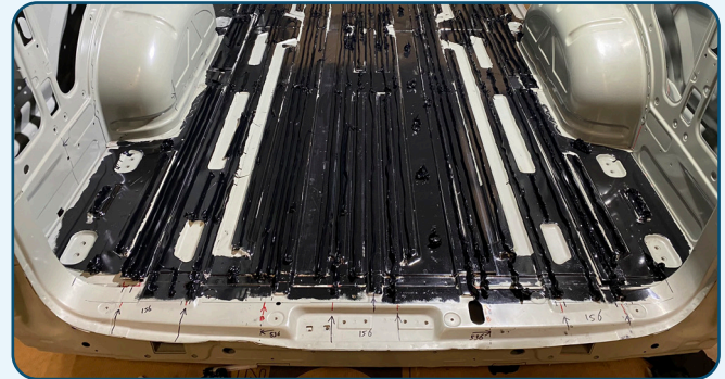
Sikaflex 268 / Sika 268 PowerCure toegepast op de voertuigvloer.
