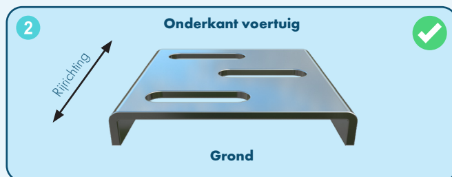
Weergave van de Lock Plate met voorbeeld van de juiste plaatsing met 90 graden rotatie
