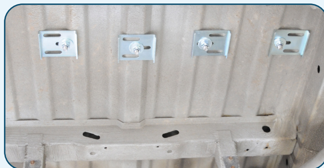
Aanzicht vanaf de onderkant van het voertuig met Lock Plates
