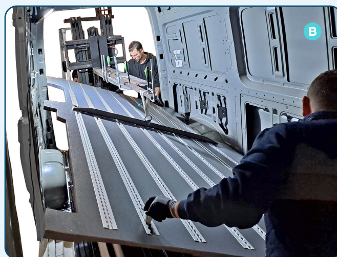
Déplacez le Smartfloor Revolution dans le véhicule
