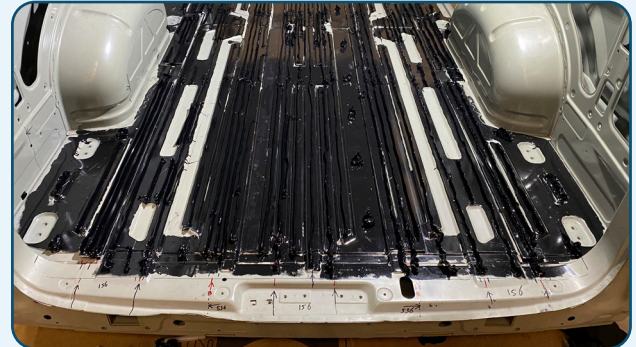
Sikaflex 268/ Sika 268 PowerCure auf den Fahrzeugboden aufgetragen
