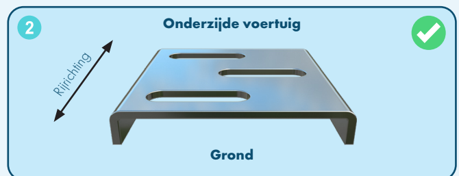
Weergave van de Lock Plate met voorbeeld van de juiste plaatsing met een rotatie van 90 graden
