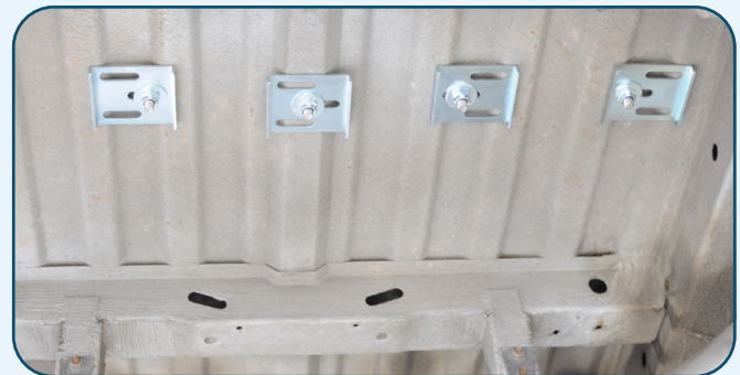
Vue du dessous du véhicule avec Lock Plates
